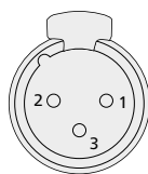
SALIDA DMX Conectores XLR (vista trasera)
